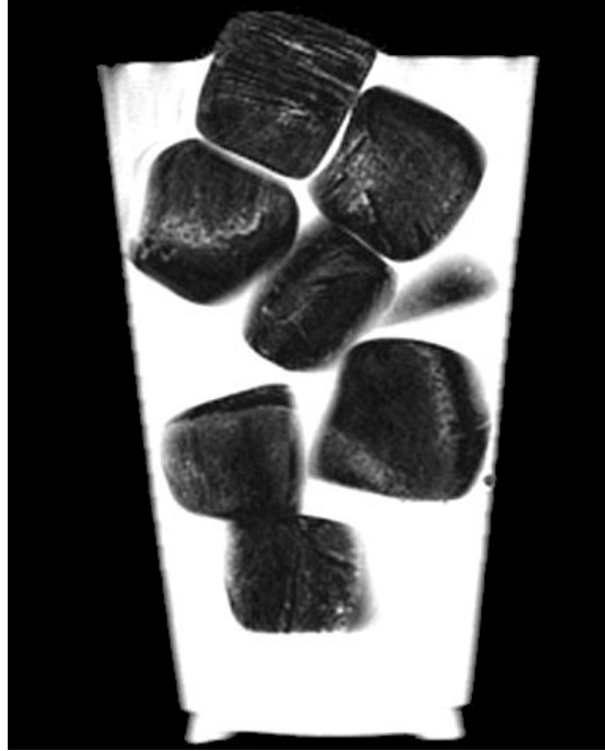
Abbildung 25: T_2 -gewichtetes Bild von Eiswürfel in Wasser. Während Wasser durch eine lange T_2 -Zeit ein helles Signal gibt, erfolgt die T_2 -Relaxation im Eis so schnell, daß von dort kaum ein Signal ausgeht. (Die T_1 -Zeit von Eis ist außerdem so lang, daß Sättigung unvermeidlich ist.)
